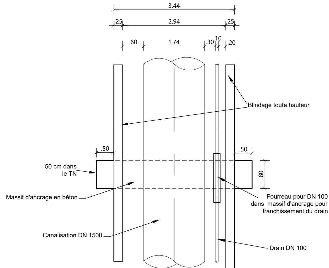
Tranchée canalisation + drain + massif d'ancrage
